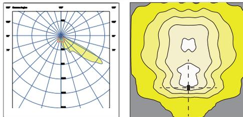
I dati fotometrici nominali sono riferiti alle sole sorgenti LED nella versione standard, ovvero con temperatura di colore 4000 K, indice di resa cromatica CRI 70 min. e temperatura di giunzione  $t_j$  pari a 25°C. I dati nominali sono estrapolati dalla scheda tecnica del costruttore.
