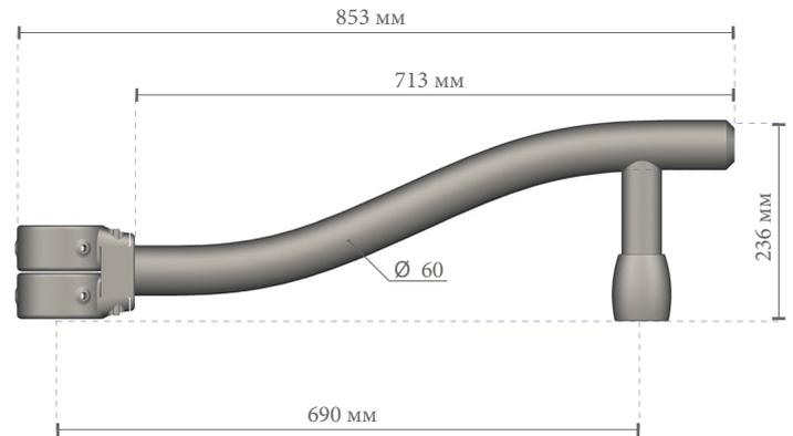
На изображениях кронштейн с крепёжными хомутами Ø 89 для установки на опоры Steel Black. Для установки на опоры Steel Red или Steel Green кронштейн оснащён хомутами Ø 79, которые изображены внизу.
