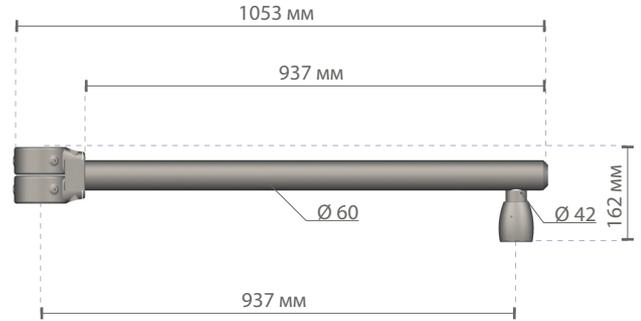
На изображениях кронштейн с крепёжными хомутами Ø 89 для установки на опоры Steel Black. Для установки на опоры Steel Red или Steel Green кронштейн оснащён хомутами Ø 79, которые изображены внизу.
