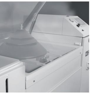
Испытания на воздействие соляного тумана | FLORIDA TEST
