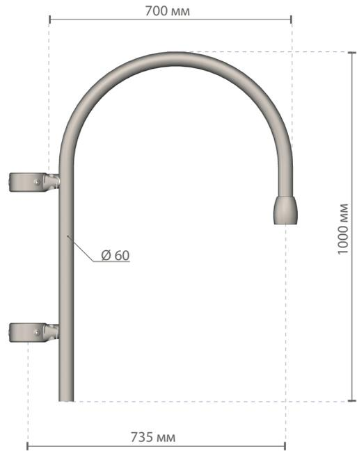
На изображениях кронштейн с крепёжными хомутами Ø 89 для установки на опоры Steel Black. Для установки на опоры Steel Red кронштейн оснащён хомутами Ø 79, которые изображены внизу.
