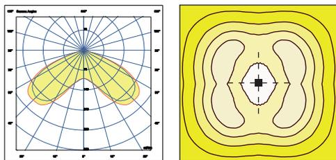
Los datos fotométricos están referidos a los productos en la versión estandar, con temperatura de color de 4000K, óptica de referencia tipo 3A y temperatura ambiente de 25°C. En el caso de cálculos iluminotécnicos con corriente de arranque y/o temperatura de color diferente a la estandar, utilizar el factor de conversión para el flujo lumínico que aparece en la tabla.
