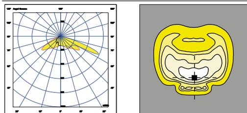
Los datos fotométricos nominales se refieren únicamente a fuentes LED en la versión estándar, es decir, con temperatura de color 4000 K, índice de reproducción cromática CRI 70 min. y temperatura de unión tj de 25°C. Los datos nominales se extrapolan de la ficha técnica del fabricante
