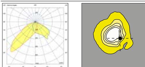
Los datos fotométricos nominales se refieren únicamente a fuentes LED en la versión estándar, es decir, con temperatura de color 4000 K, índice de reproducción cromática CRI 70 min. y temperatura de unión tj de 25°C. Los datos nominales se extrapolan de la ficha técnica del fabricante
