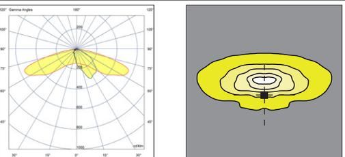
Los datos fotométricos están referidos a los productos en la versión estandar, con temperatura de color de 4000K, óptica de referencia tipo 3A y temperatura ambiente de 25°C. En el caso de cálculos iluminotécnicos con corriente de arranque y/o temperatura de color diferente a la estandar, utilizar el factor de conversión para el flujo lumínico que aparece en la tabla.
