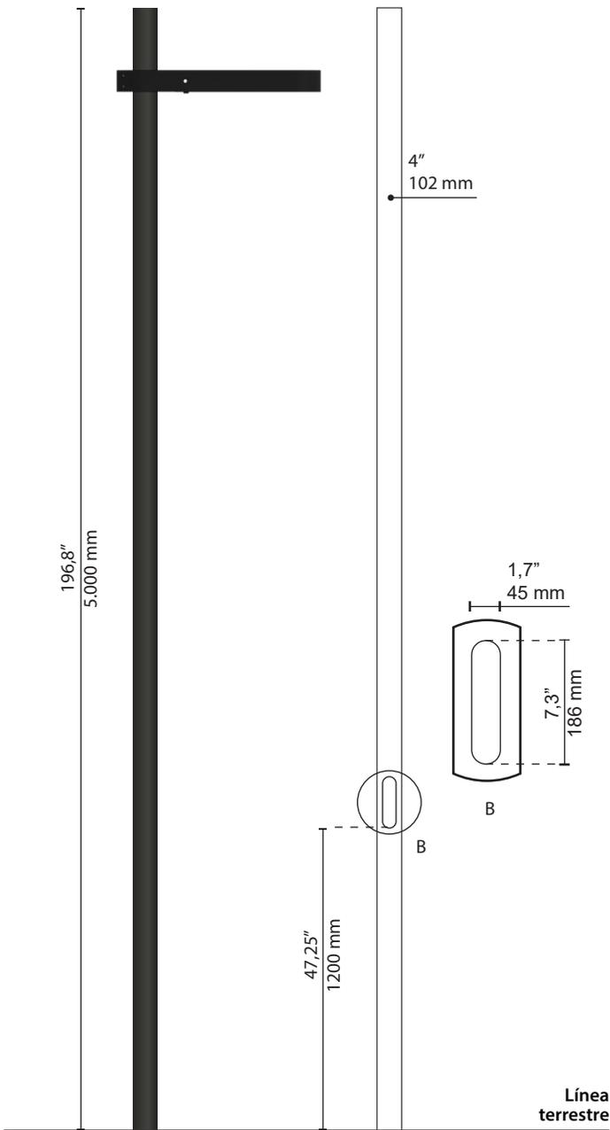
(\*)La posición de los módulos sigue el proyecto de iluminación en altura y orientación
